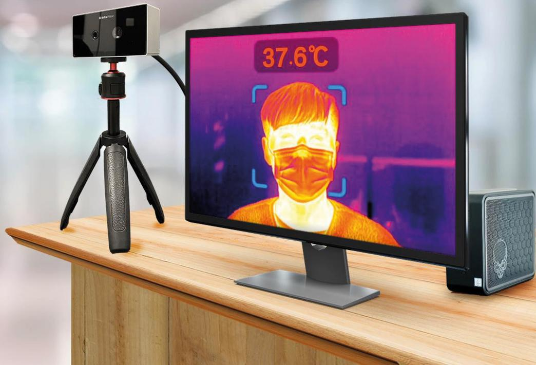
La cámara Crambo Thermal Point está dotada de tecnología por infrarrojos de corto alcance lo que permite realizar la medición de la temperatura corporal precisa y reconocimiento facial de gran calidad (con y sin mascarilla). Todo, en un solo dispositivo Plug&Play.
