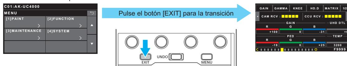
Quando se muestra la pantalla de estado, si pulsa “◀” y “▶” en ambos lados cambiará la información mostrada en la pantalla de estado.
