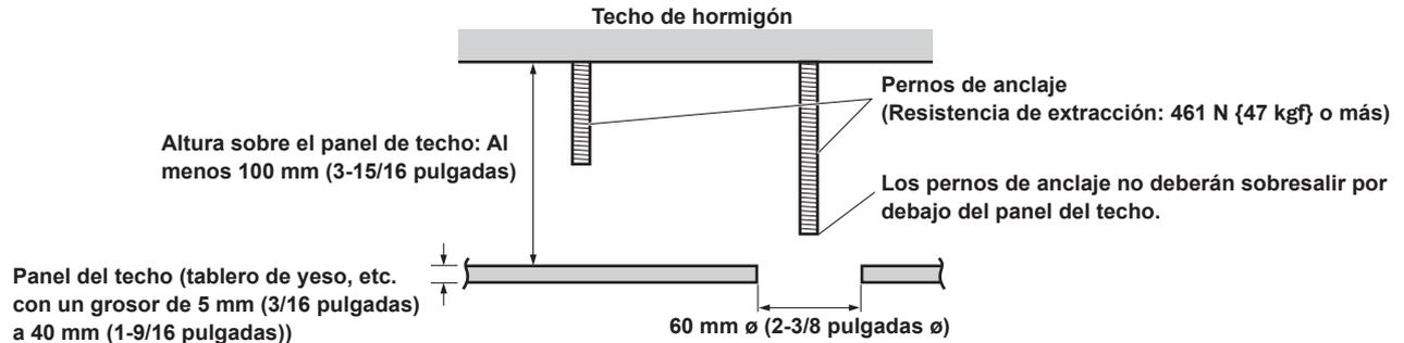
1. Consulte las instrucciones de funcionamiento de la ménsula de montaje directo en el techo WV-Q105A, y colóquela en los pernos de anclaje junto con la pieza angular del cable para impedir caídas y el propio cable para impedir caídas suministrado con la WV-Q105A.
