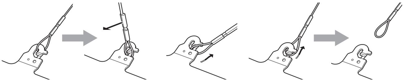
① Tire del cable para impedir caídas en el sentido mostrado por la flecha de arriba.
