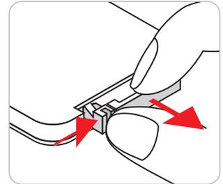
2. Coloque una pila nueva en el compartimento. Extraiga la pila usada y coloque una nueva (CR2025). Asegúrese de que el lado con un signo "+" quede hacia arriba.
