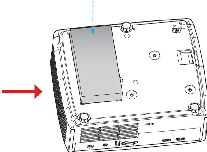
2. Asegure el adaptador de CA con la brida para cables.
