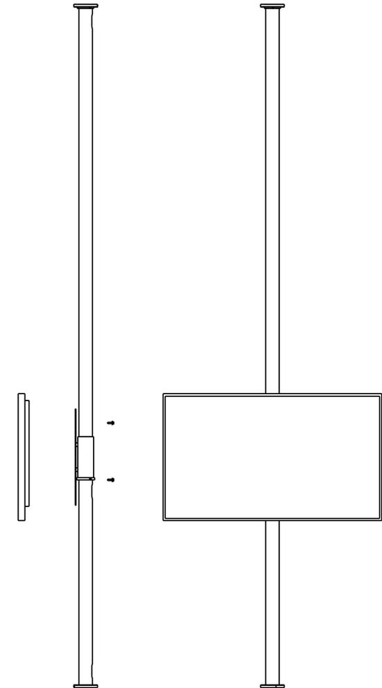
Ajustar el anillo del sistema giratorio con la altura que desea instalar el monitor. Fijar monitor a la columna
