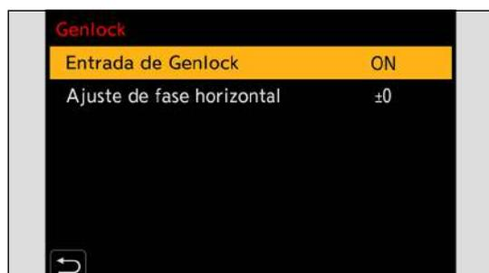
**3 Transmita una señal de sincronización con el generador de señal de sincronización.**
